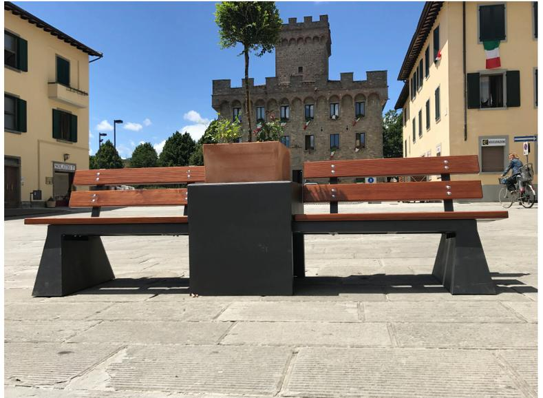
Le caratteristiche principali hanno riguardato l'adattamento delle strutture in ferro alla superficie inclinata della piazza ed inoltre sono state dimensionate in modo da mantenere stabilità, ma potere anche essere agevolmente e rapidamente spostate tramite l'uso del nostro escavatore, quando si renda necessaria la disponibilità della piazza libera da strutture, in occasione di manifestazioni e ricorrenze, come la cena della Misericordia, raduni automobilistici, ecc.
