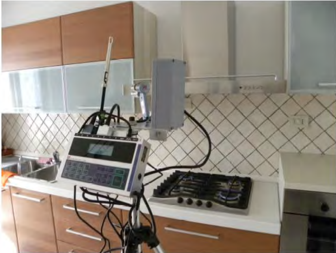
Fig. I.1-14: Centralina di rilevazione e registrazione
