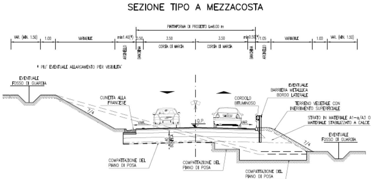
**Figura 18 - Sezione tipo di intervento nelle varianti plano-altimetriche**
